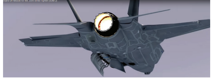
F-35 bir kara hedefini vurmak üzere SOM-J seyir füzesini ateşlerken. Görsel Lockheed Martin'in ROKETSAN ile Türk seyir füzesi için dahili taşıma entegrasyonunu tanıttığı resmi web sayfasından alınmıştır. 86
